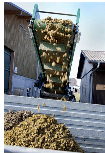
Das Endprodukt: Der Separator filtert aus der Bschrütti Feststoffe raus.
